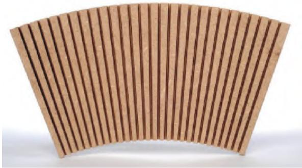
Radiale Schlitzung in MDF-Trägerwerkstoff
