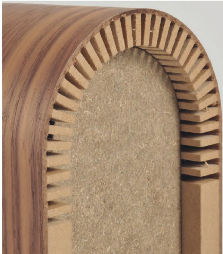
Schlitze nur im Bereich der Rundung stabilisieren das Bauteil
