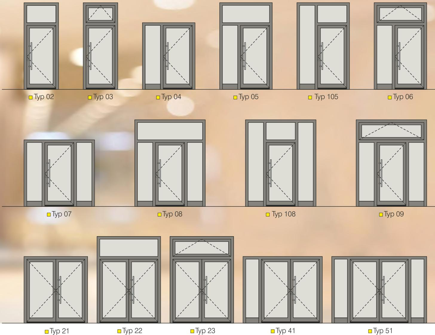
Alle Modelle des Select Programms können in unterschiedlichen Ausführungen mit Seitenteilen und Oberlichten und der dementsprechenden Öffnungsart der DIN Richtung (Links-Rechts) gefertigt werden.
