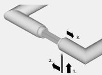
Zur **Demontage** von unten den Klemmechanismus entriegeln und **Drücker abziehen**.
