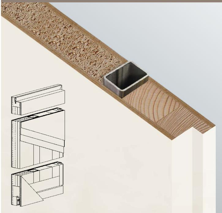
Türblattaufbau mit Aluminiumverbundabsperung
