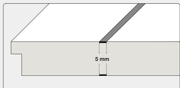
Die ca. 5 mm breite Lines PLAN Applikation ist **bündig** in das Türblatt eingelassen und in ›Schwarz‹, ›Nickel-Optik‹ und ›Edelstahl-Optik‹ erhältlich.
